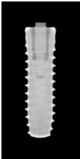
Fig. 1: Sistema BionIQ – Radiografía de rotura bajo la cabeza del tornillo.
