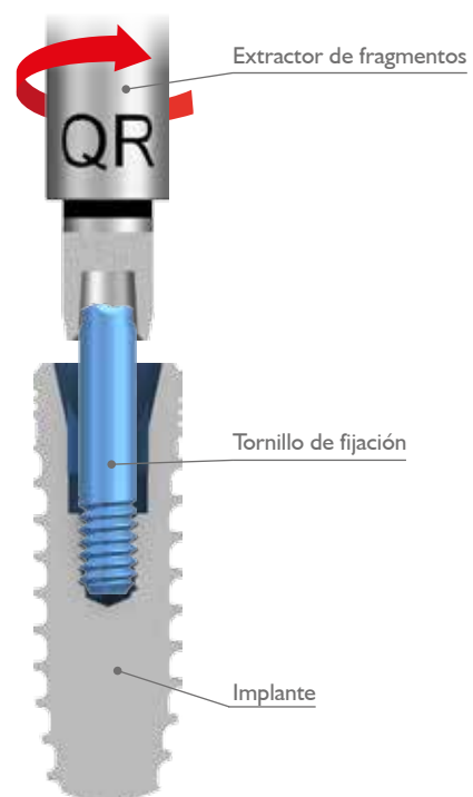
Fig. 2: Sistema BionIQ – Retirada del tornillo mediante el extractor de fragmentos.
