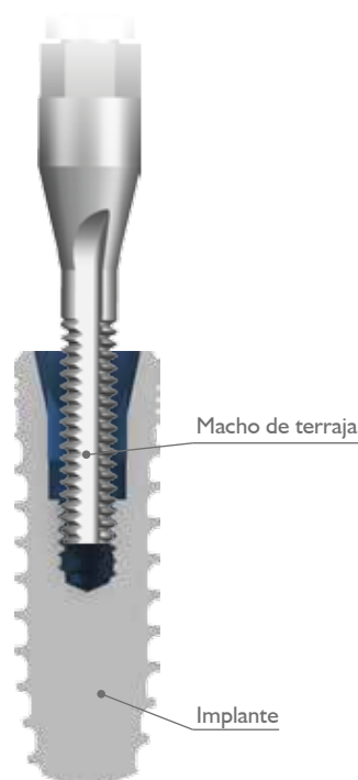
Fig. 9: Sistema BioniQ – Uso del macho de terraja para la renovación de la rosca interna del implante.
