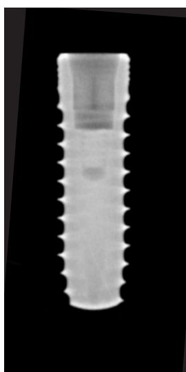
Fig. 3: Sistema BioniQ – Radiografía de rotura del tornillo a la altura de su rosca.
